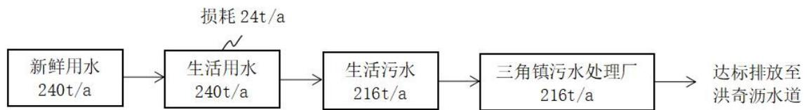
图 1 水平衡图（单位：t/a）
